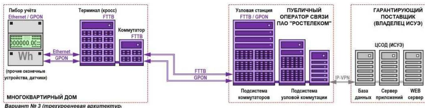
Рисунок № 1 Организация каналов (линий) связи на базе интерфейсов Ethernet, FTTB или GPON Жилые и нежилые помещения в многоквартирном доме должны быть оснащены средствами измерений, иным оборудованием и нематериальными активами, соответствующими требованиям минимального набора функций, утвержденным Постановлением № 890, формирующими ИИК (нижний уровень).
